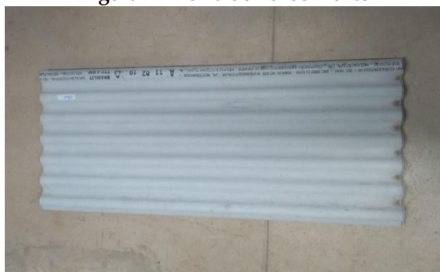
Figura 4 – Telha de fibrocimento
