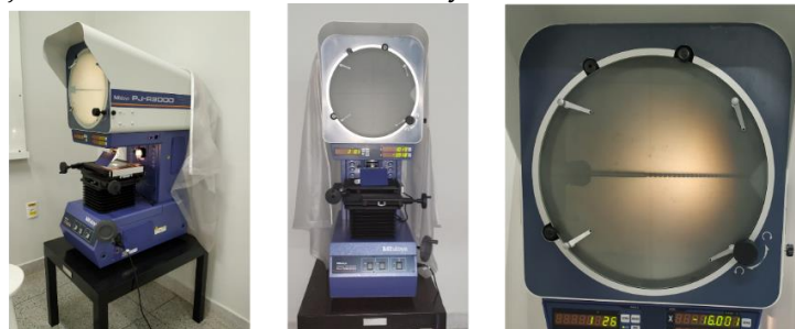
Figura 02: Projetor de Perfil PJ-A3000 Mitutoyo, utilizado nas análises dimensionais
