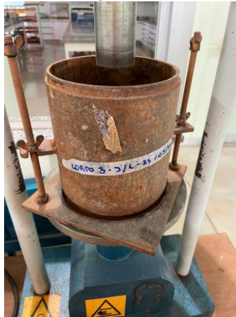
Figura 4: Execução do ensaio de CBR
