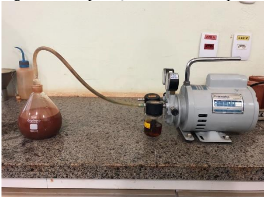
Figura 2a – Aplicação de vácuo no picnômetro
