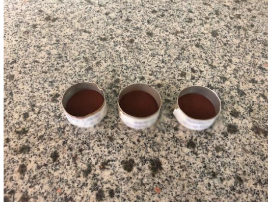
Figura 1 – Determinação da umidade contida no solo
