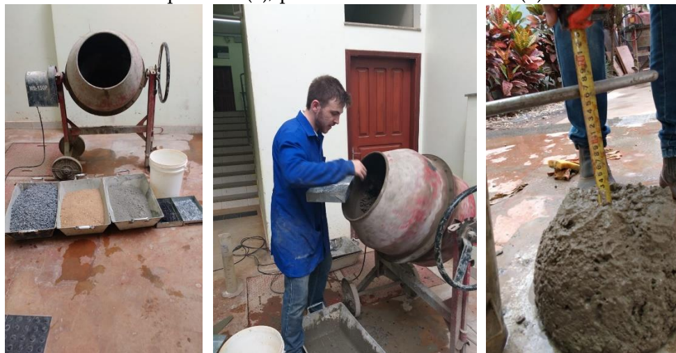
Figura 3 - Materiais separados (a), processo de amassamento (b) e teste de slump (c)
