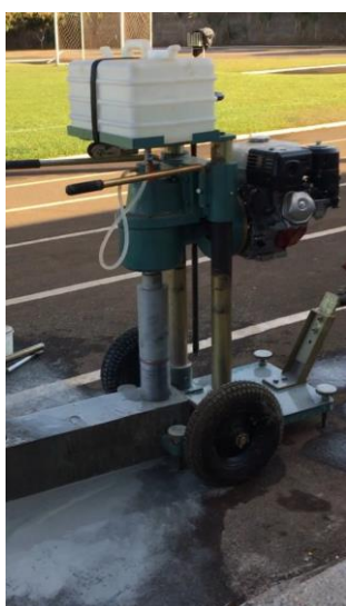
FIGURA 2. Extração de testemunhos
