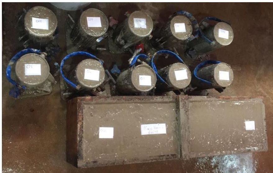
Figura 1. Moldagem de corpos de prova e viga
