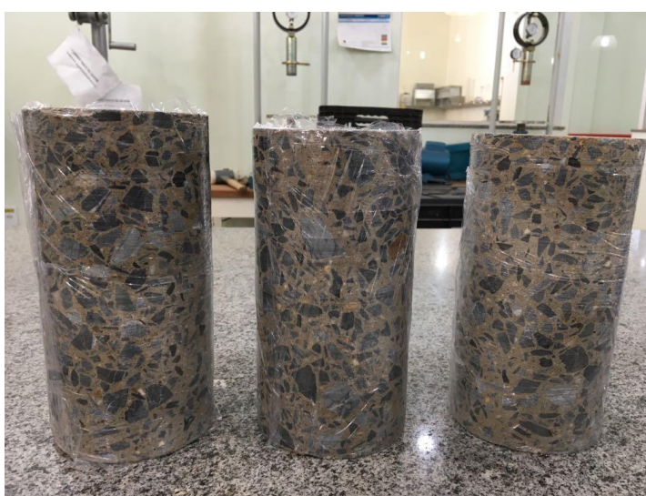
FIGURA 2. Extração de testemunhos
