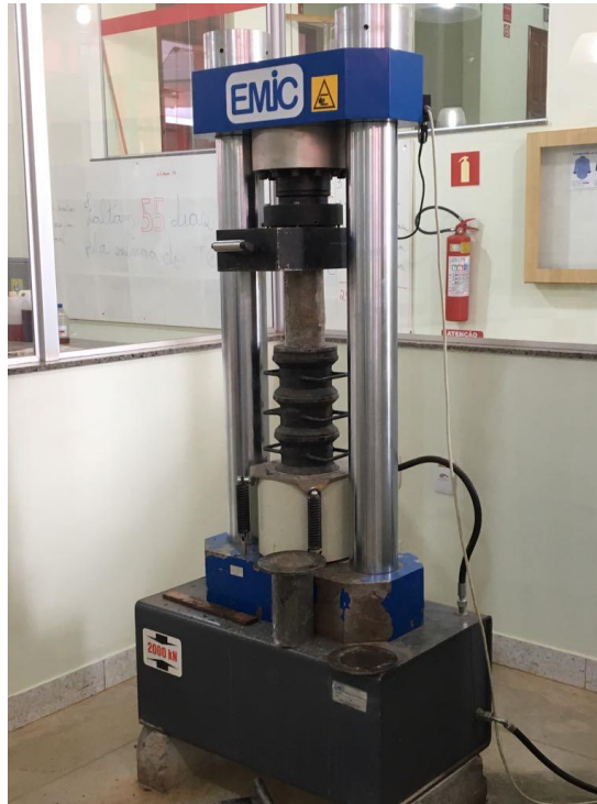
FIGURA 4. Ensaio de compressão axial
