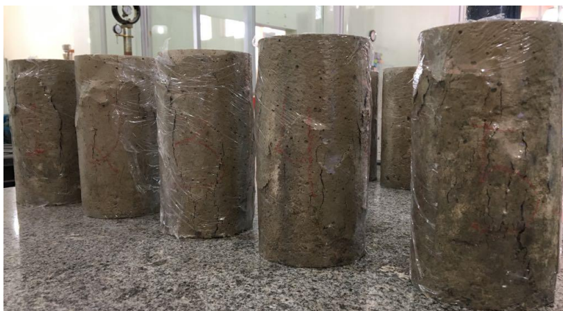
FIGURA 5. Linhas de ruptura adensamento manual
