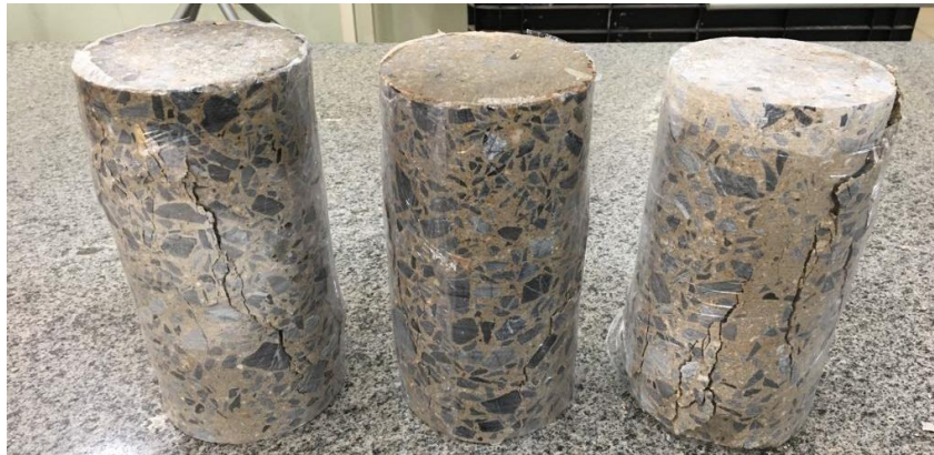
FIGURA 7. Linhas de ruptura testemunho
