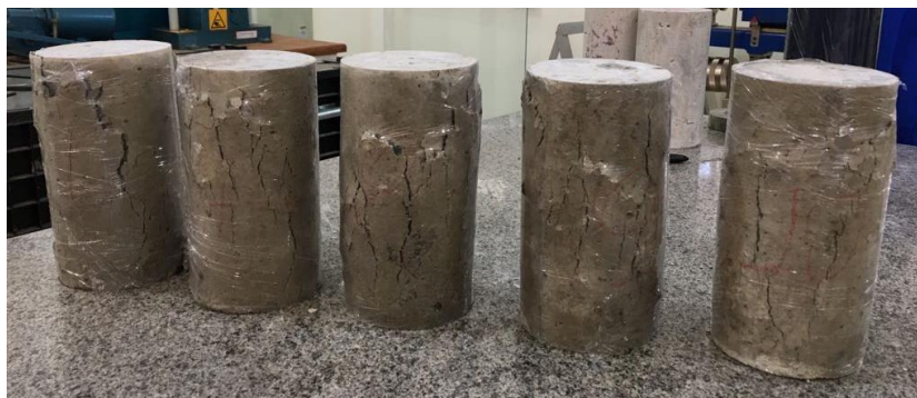
FIGURA 6. Linhas de ruptura adensamento mecânico
