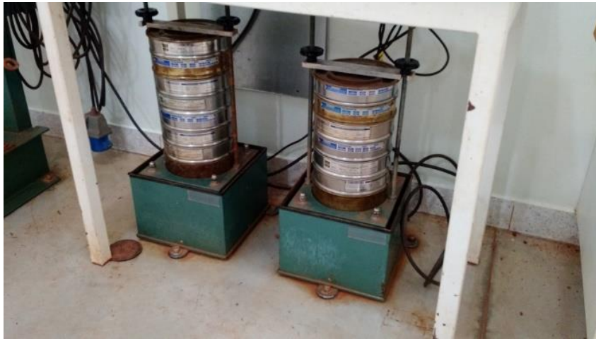
FIGURA 9. Peneiramento por agitação
