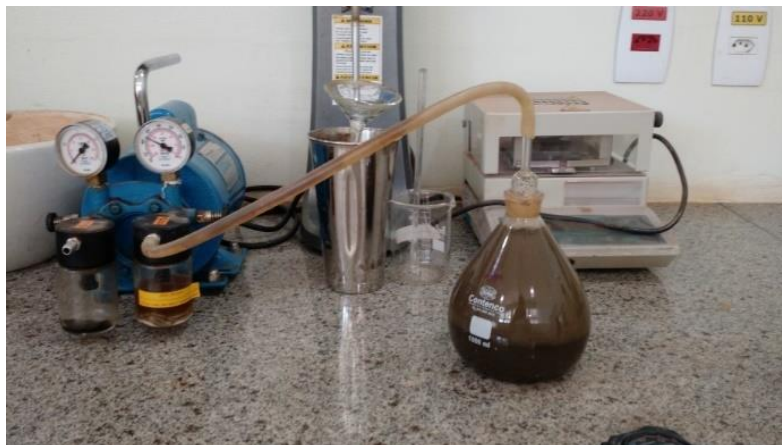
FIGURA 8. Retirada de ar por pressão do lodo
