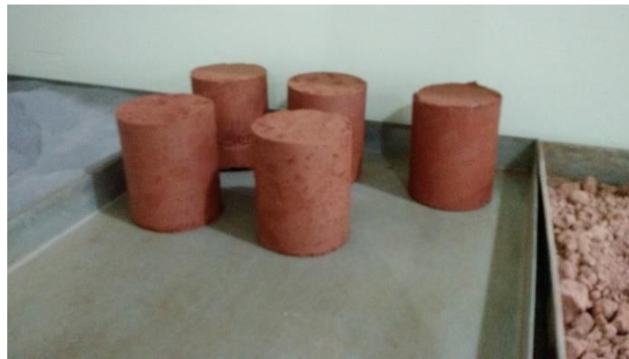
FIGURA 6. Corpos de prova do ensaio de Compactação com diferentes teores de umidade
