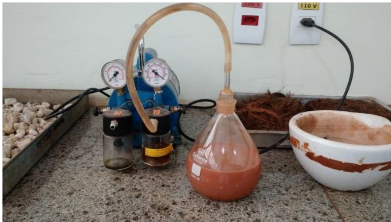
FIGURA 7. Retirada de ar por pressão do solo
