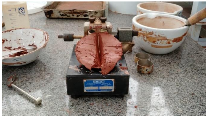
FIGURA 3. Ensaio de Limite de Liquidez
