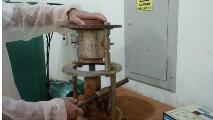
FIGURA 6. Corpos de prova do ensaio de Compactação com diferentes teores de umidade
