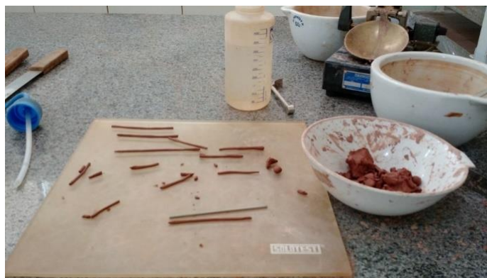
FIGURA 4. Ensaio de Limite de Plasticidade
