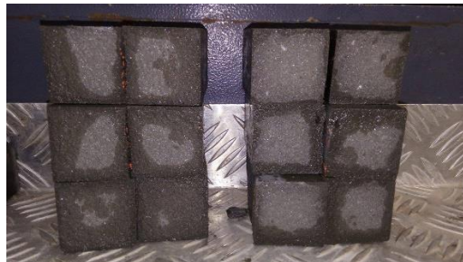
FIGURA 1. Corpos de prova após ruptura
