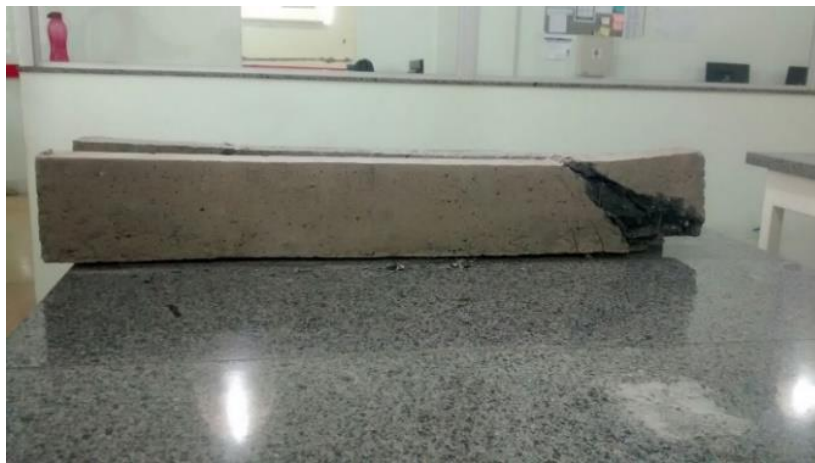
FIGURA 8. Deformação na viga após o rompimento
