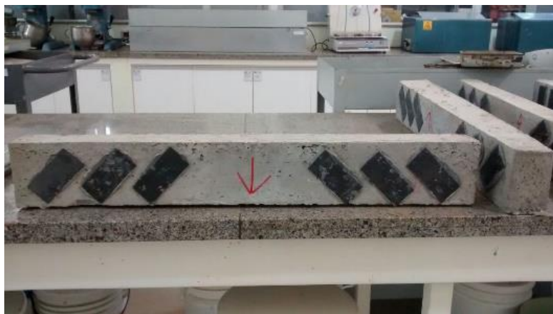
FIGURA 4. Reforço estrutural no ângulo de quarenta e cinco graus (45°)
