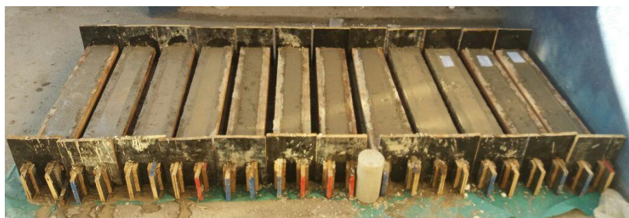
FIGURA 1. Vigas concretadas e identificadas de acordo com a armadura
