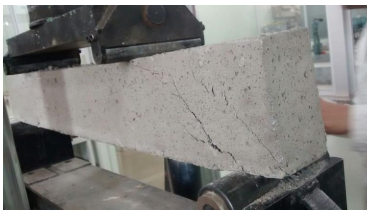
FIGURA 6. Rompimento da viga modelo ao cisalhamento
