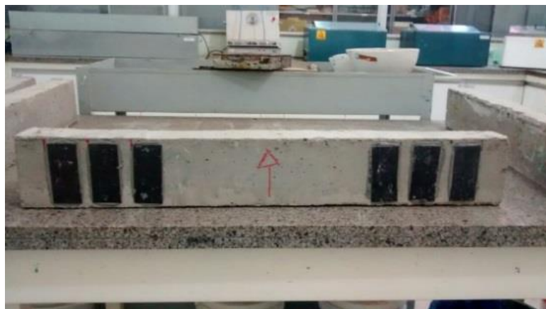
FIGURA 3: Reforço estrutural no ângulo de noventa graus ( 90^\circ )
