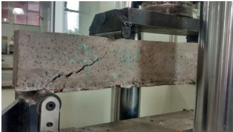
FIGURA 7. Rompimento da viga modelo com 70% da armadura transversal ao cisalhamento
