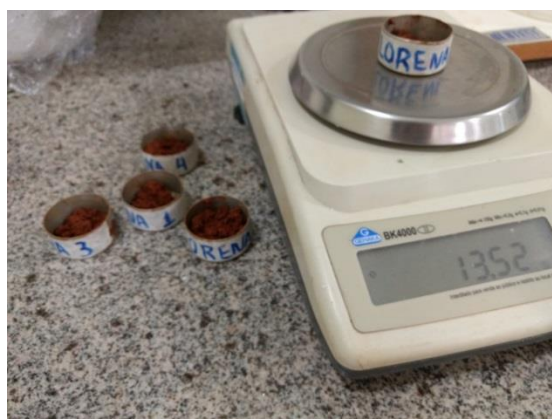
FIGURA 6. Verificação de umidade
