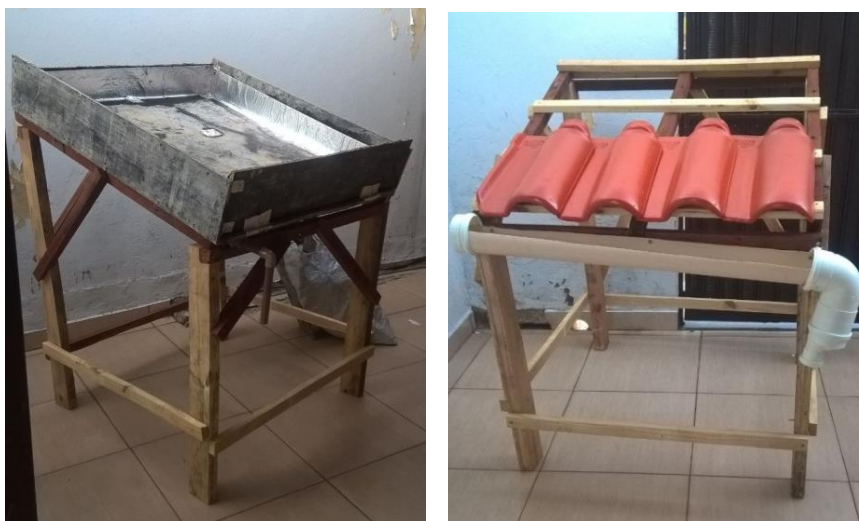
FIGURA 2. Protótipo do telhado verde (esquerda) e telhado convencional (direita)
