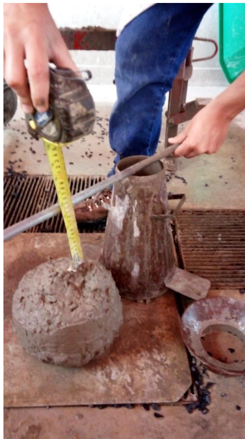
Figura 2. Realização do teste de slump
