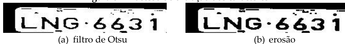
Figura 8 - Processo de extração dos caracteres
