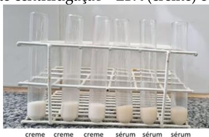
Figura 7: Teste centrifugação - LBX (creme) e LBIV (sérum).
