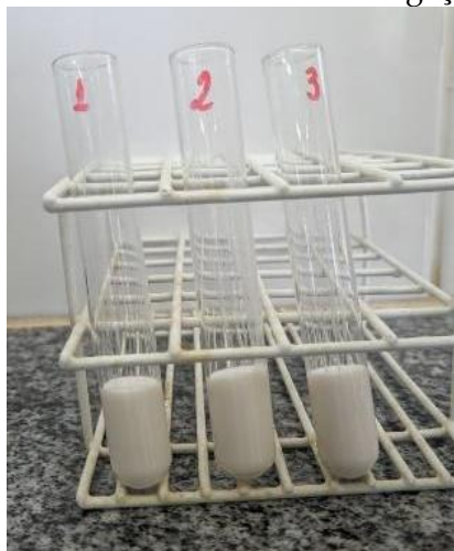
Figura 5: Resultado do teste de centrifugação para LB3
