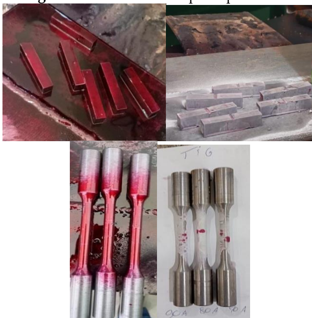
Figura 12: Análise com líquido penetrante
