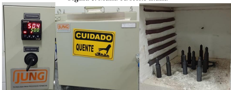
Figura 8: Mufla ou forno mufla
