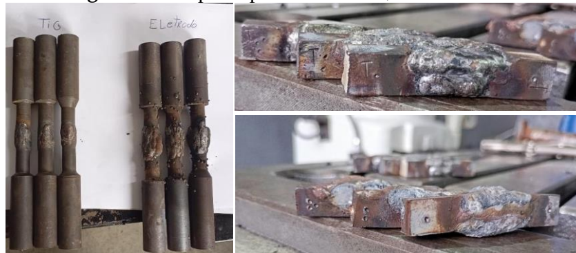
Figura 11: Corpos e prova soldados, análise visual
