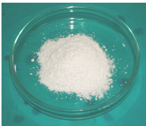
Figura 10. Acetato de Cálcio purificado e pulverizado
