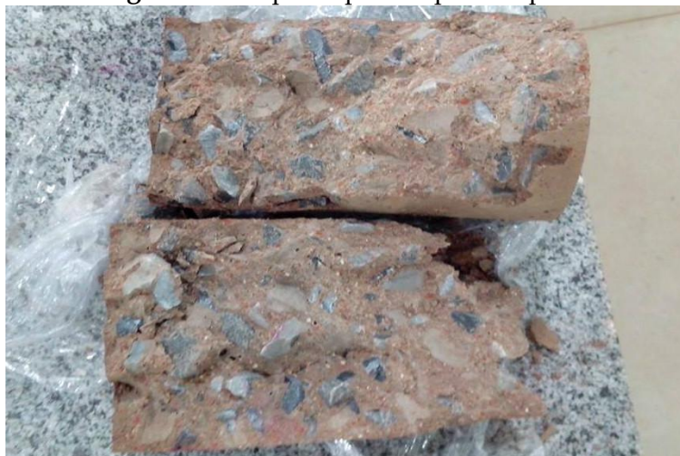
Figura 6 – Corpo de prova após a ruptura
