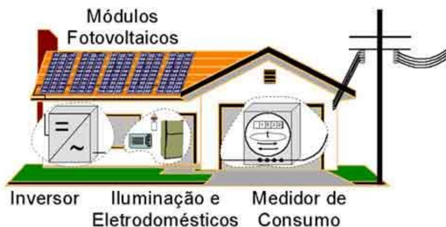
Figura 5. Esquema de um sistema fotovoltaico conectado à rede
