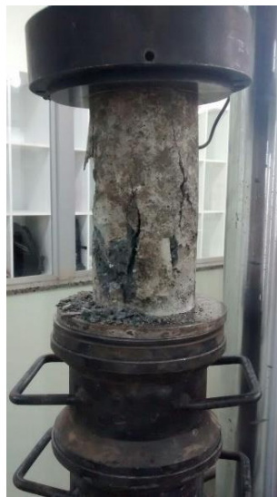
FIGURA 5. Ensaio de compressão axial nos corpos de prova
