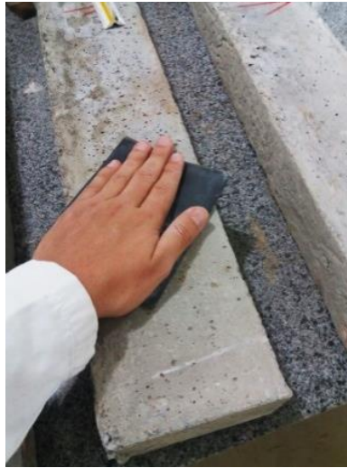
FIGURA 2: Preparação das vigas para fixação do PRFC
