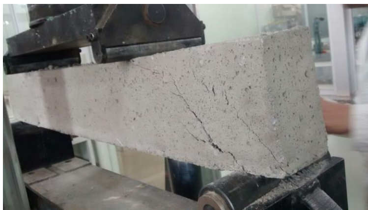
FIGURA 6. Rompimento da viga modelo ao cisalhamento
