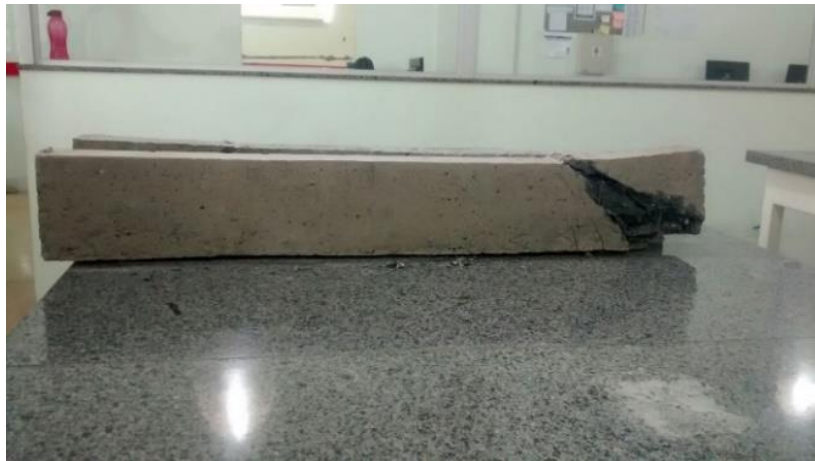
FIGURA 8. Deformação na viga após o rompimento
