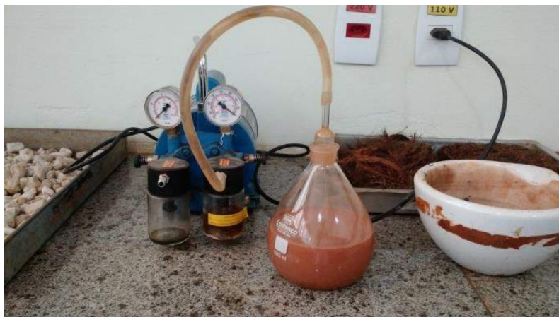
FIGURA 7. Retirada de ar por pressão do solo
