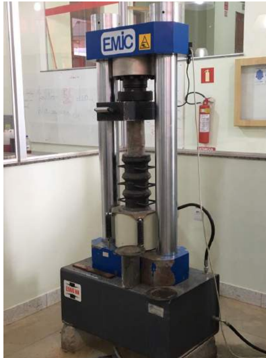
FIGURA 4. Ensaio de compressão axial
