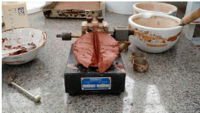
FIGURA 3. Ensaio de Limite de Liquidez
