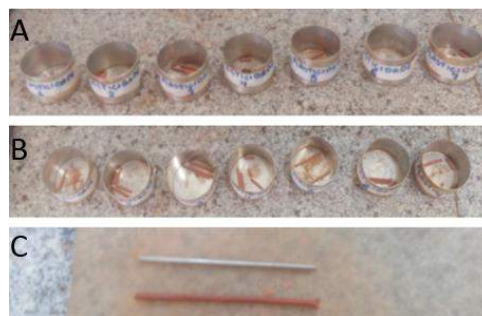
FIGURA 7. Amostras para ensaio de Limite de Plasticidade
