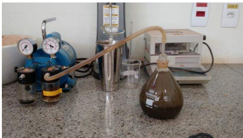
FIGURA 8. Retirada de ar por pressão do lodo
