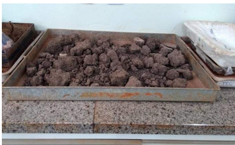
FIGURA 4. Amostra de lodo bruto disposto em bandeja para secagem
