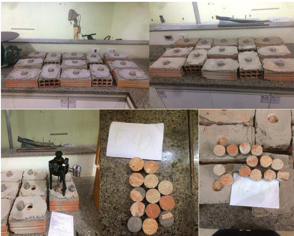
IMAGEM 4. Ensaio de arrancamento
