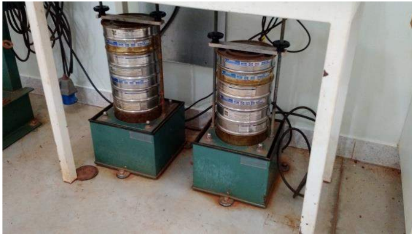
FIGURA 9. Peneiramento por agitação
