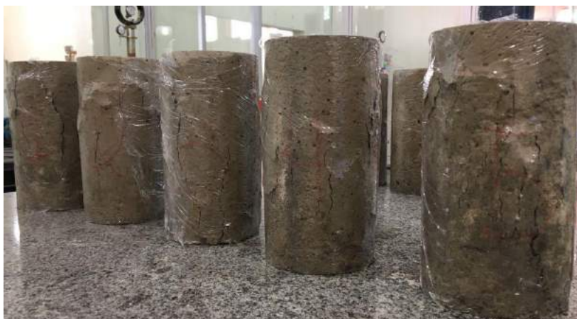
FIGURA 5. Linhas de ruptura adensamento manual
