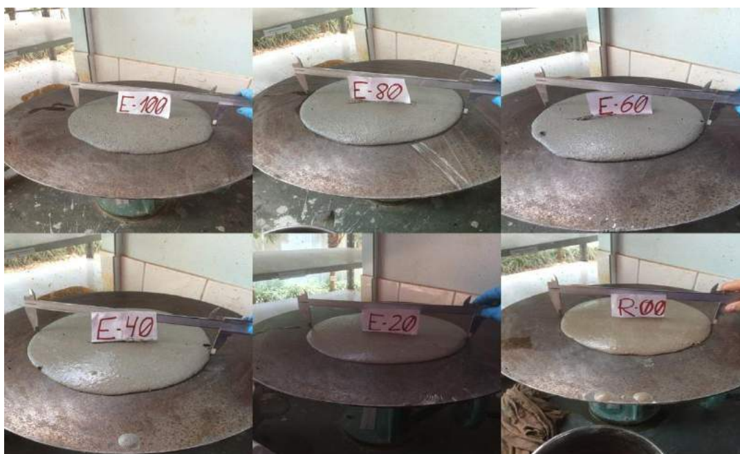
IMAGEM 1. Consistência das Argamassas
