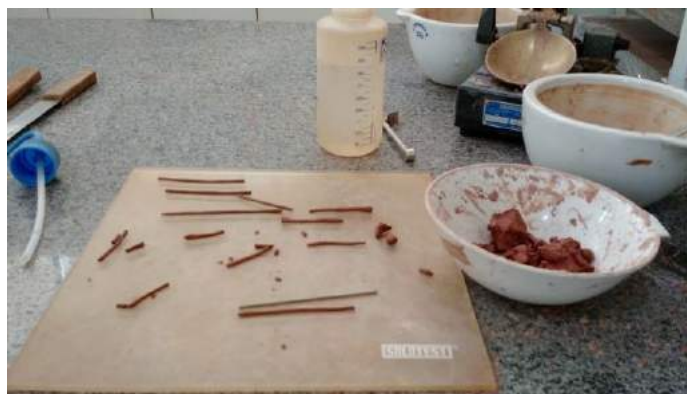
FIGURA 4. Ensaio de Limite de Plasticidade
