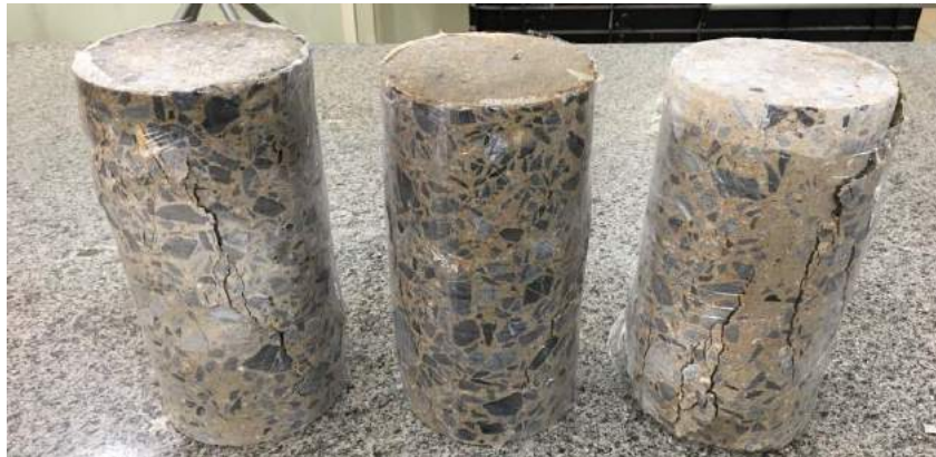
FIGURA 7. Linhas de ruptura testemunho
