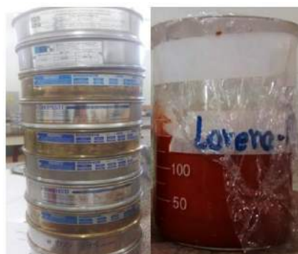
FIGURA 5. Série de peneiras e mistura do solo com solução após 14hs para ensaio de sedimentação
