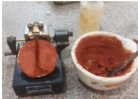
FIGURA 6. Pasta para ensaio de Limite de Liquidez
