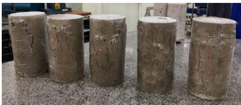
FIGURA 6. Linhas de ruptura adensamento mecânico
