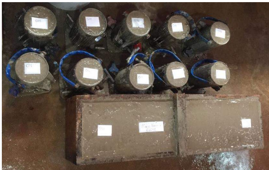
Figura 1. Moldagem de corpos de prova e viga
