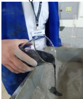
Figura 5 – Dispersão do NTC na água com utilização do banho ultrassônico
