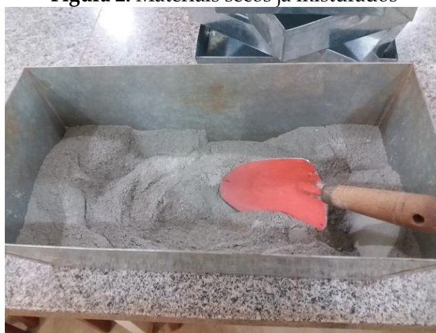
Figura 2: Materiais secos já misturados
