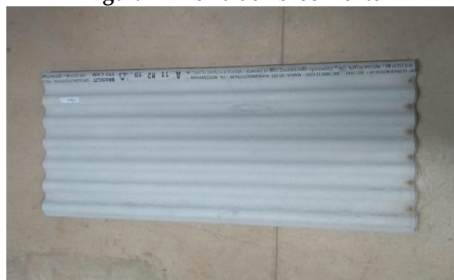
Figura 4 – Telha de fibrocimento
