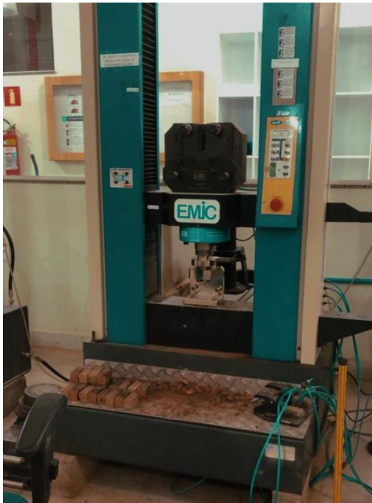
Figura 3 — Ensaio de resistência à compressão, realizado através da prensa Emic.
