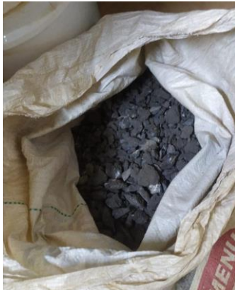
Figura 3: Material fresado no estado bruto
