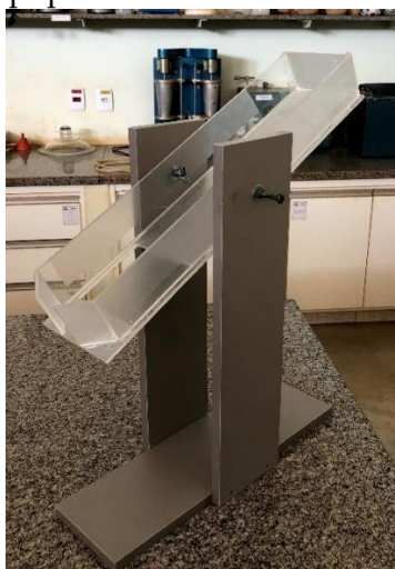
Figura 5: Equipamento de Inderbitzen modificado
