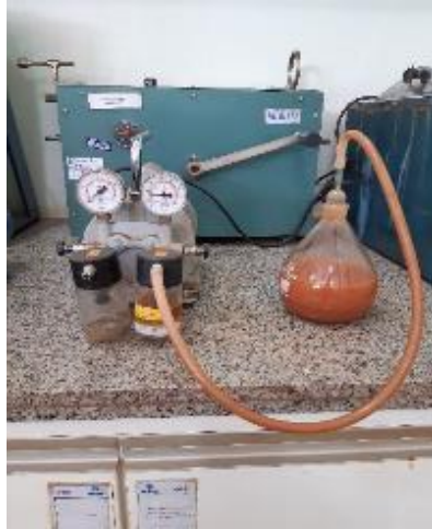
Figura 3: Ensaio de massa específica pelo método do picnômetro.
