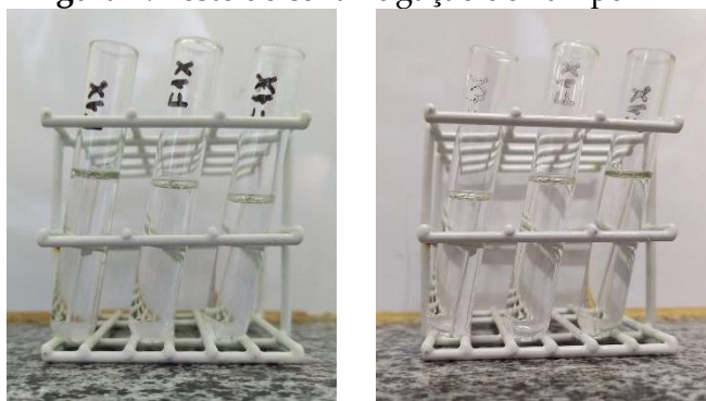
Figura 1: Teste de centrifugação do xampu F1X
