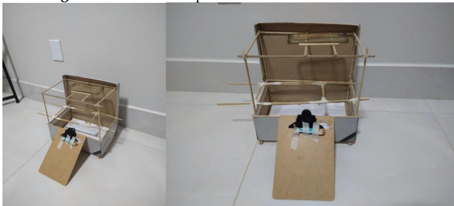
Figura 1: Estrutura Simplificada de uma Rostrum Camera
