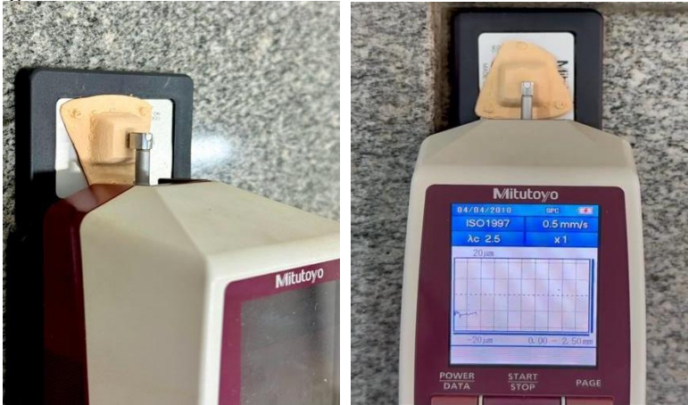
Imagem 16: A) Rugosímetro realizando a leitura do modelo de gesso pedra tipo IV; B) Rugosímetro mostrando em seu visor o resultado da leitura
