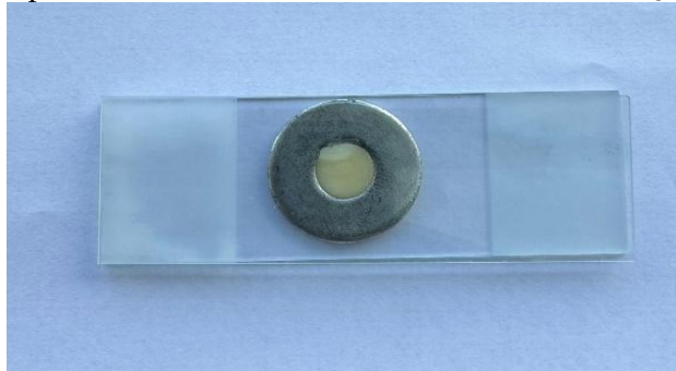
Figura 1: Corpo de prova sendo confeccionado com matriz de aço e lâmina de vidro
