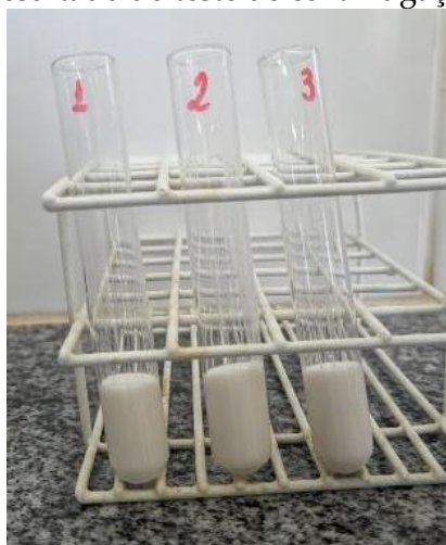
Figura 5: Resultado do teste de centrifugação para LB3
