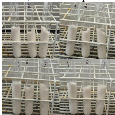
Figura 2: Resultado do teste de estresse térmico após 10 minutos em banho-maria em temperaturas de 40, 50, 60 e 70°C respectivamente para o LB1
