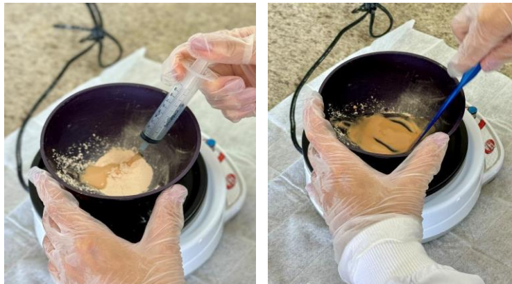
Imagem 10 e 11: manipulação do gesso odontológico tipo IV sobre o vibrador
