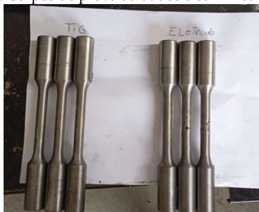
Figura 2: Corpos de prova soldados e com medidas finais
