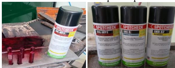
Figura 3: Ensaio não destrutivo por Líquido Penetrante
