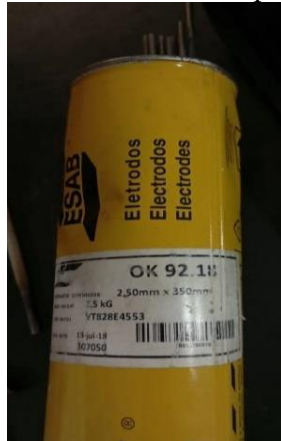
Figura 10: Eletrodo com alma de níquel puro, OK 92.18
