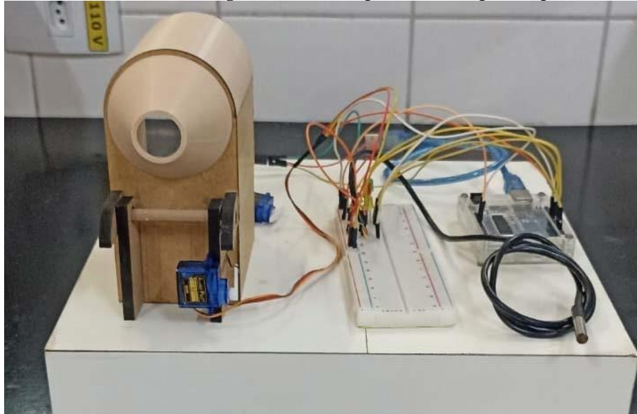
Figura 7: Torrador montado em MDF com sistema de controle baseado em Arduino, ilustrando a integração dos componentes no protótipo.
