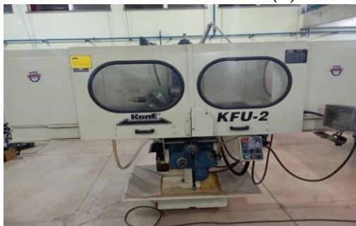
Figura 1: Máquinas para usinagem: (A) Fresadora Universal KFU 2 e (B) Torno Clever L – 1640
