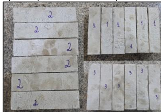
Figura 3: Corpos de prova de concreto após a desforma
