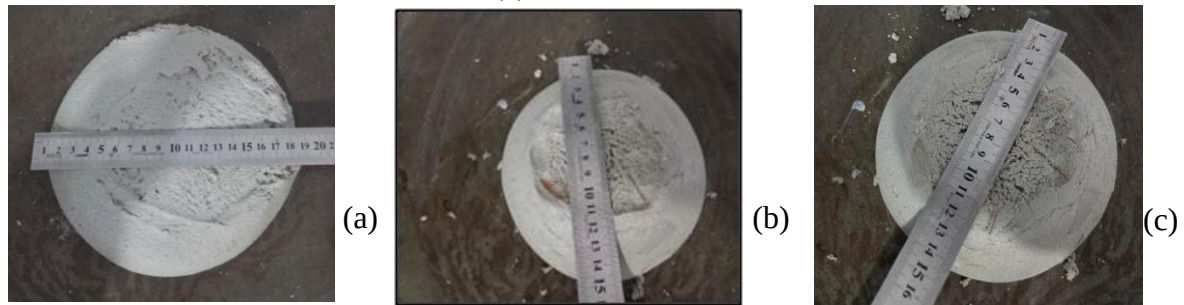
Figura 2: Ensaio de trabalhabilidade na mesa de adensamento – (a) REF; (b) 0,2% de PSA; (c) 0,3% de PSA
